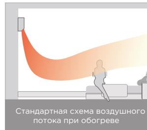
Стандартная схема воздушного потока при обогреве
