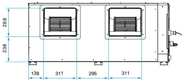
Размеры монтажного отверстия воздуховода после снятия фланца для подачи воздуха:
