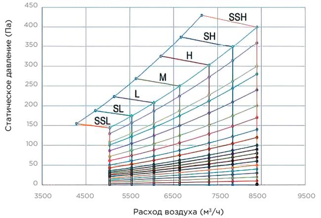
Как читать диаграмму (режим постоянного расхода воздуха). По вертикальной оси отложено внешнее статическое давление (Па), в то время как горизонтальная ось представляет расход воздуха (м³/ч). Указаны кривые для разных скоростей: SSH, SH, H, M, L, SL и SSL.
