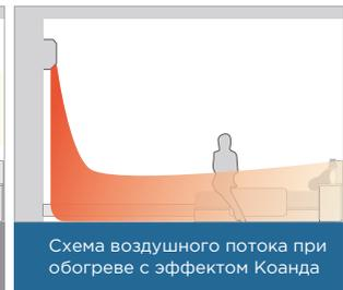
Схема воздушного потока при обогреве с эффектом Коанда
