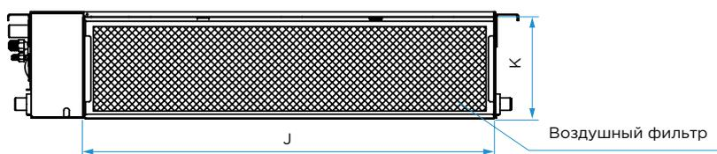
Размер отверстия для забора воздуха (воздухозабор снизу)
