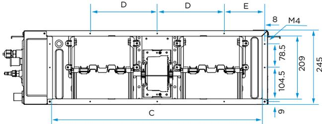
Размер воздухозаборного отверстия для обратного воздуха (режим нижнего возврата воздуха)
