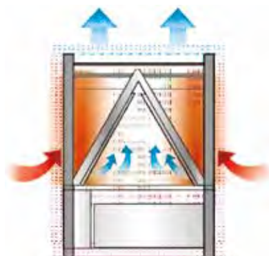
Алюминиевые ламели с гидрофильным покрытием
