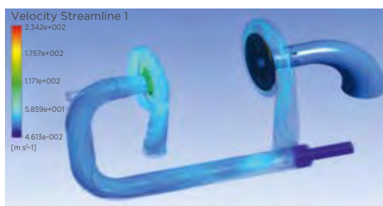
Анализ поля потока при последовательном двухступенчатом сжатии
