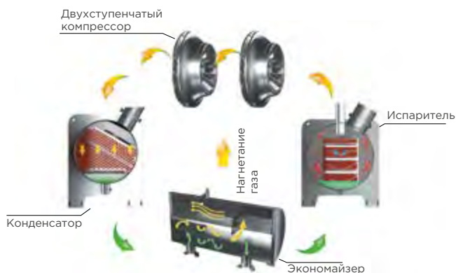
Схема технологии двухступенчатого сжатия
