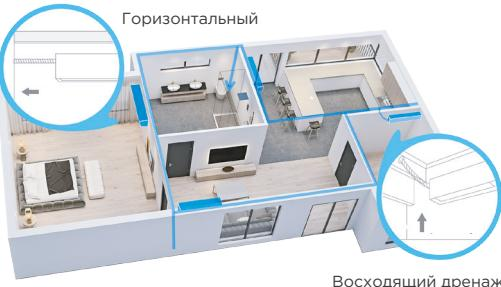
Наличие встроенного дренажного насоса расширяет возможности отведения конденсата — возможен монтаж отводящего трубопровода горизонтально или с подъемом.
