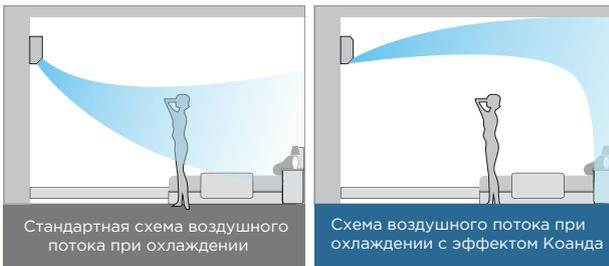
Стандартная схема воздушного потока при охлаждении
