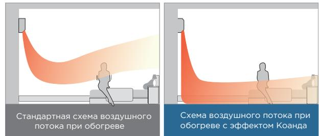
Стандартная схема воздушного потока при обогреве
