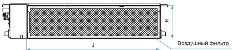
Размер отверстия для забора воздуха (воздухозабор снизу)
