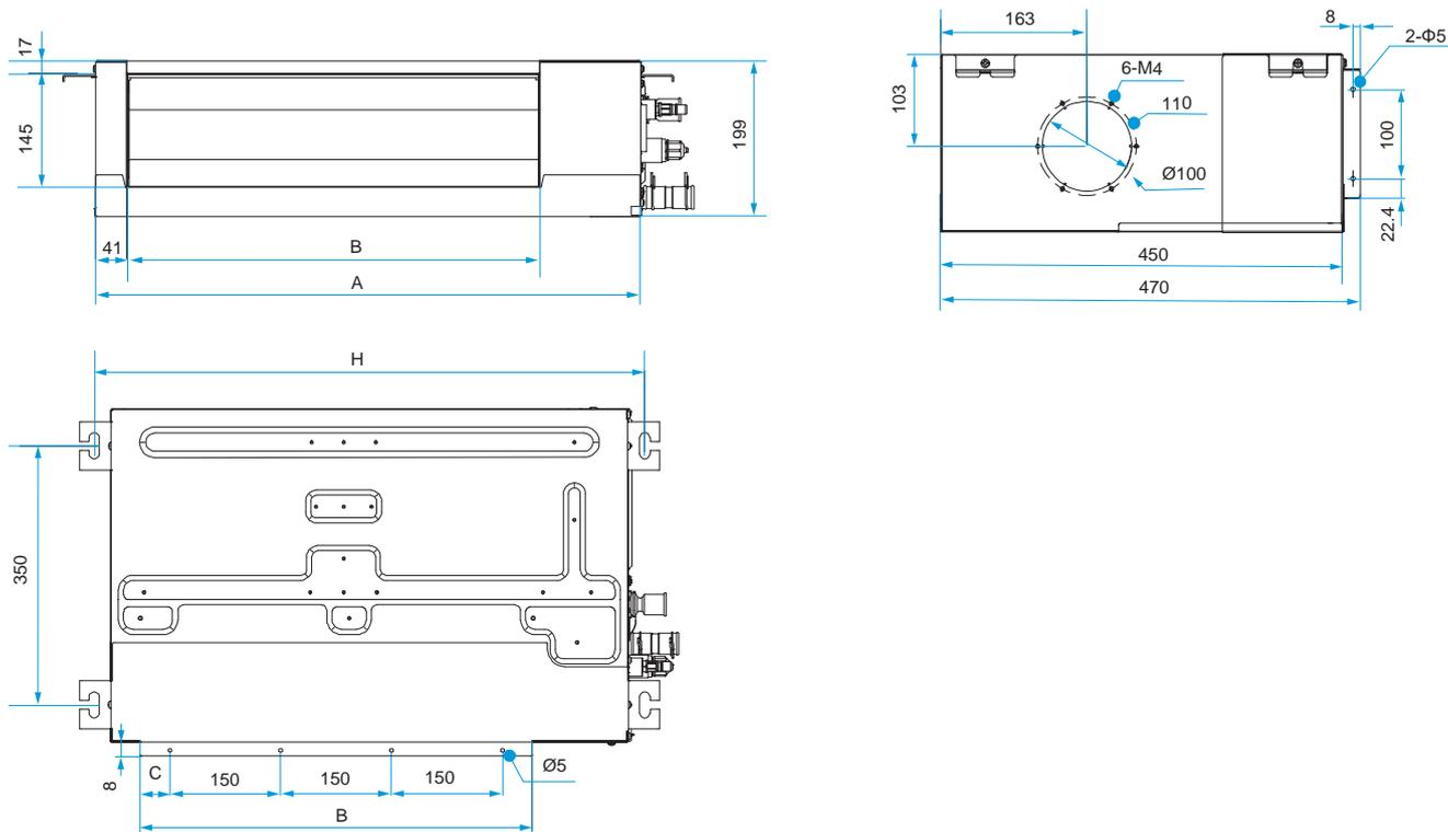
Размер воздухозаборного отверстия для обратного воздуха (режим возврата воздуха сзади)
