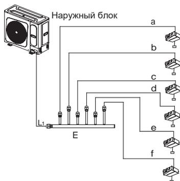
Число внутренних блоков: более 6 (способ подключения 2)
