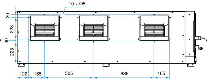
Размеры выступов и резьбового отверстия фланца для выпуска/впуска воздуха
