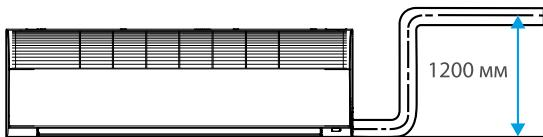
\* Со встроенными дренажными насосами поставляются модели MIH\_GHN18(DP).
