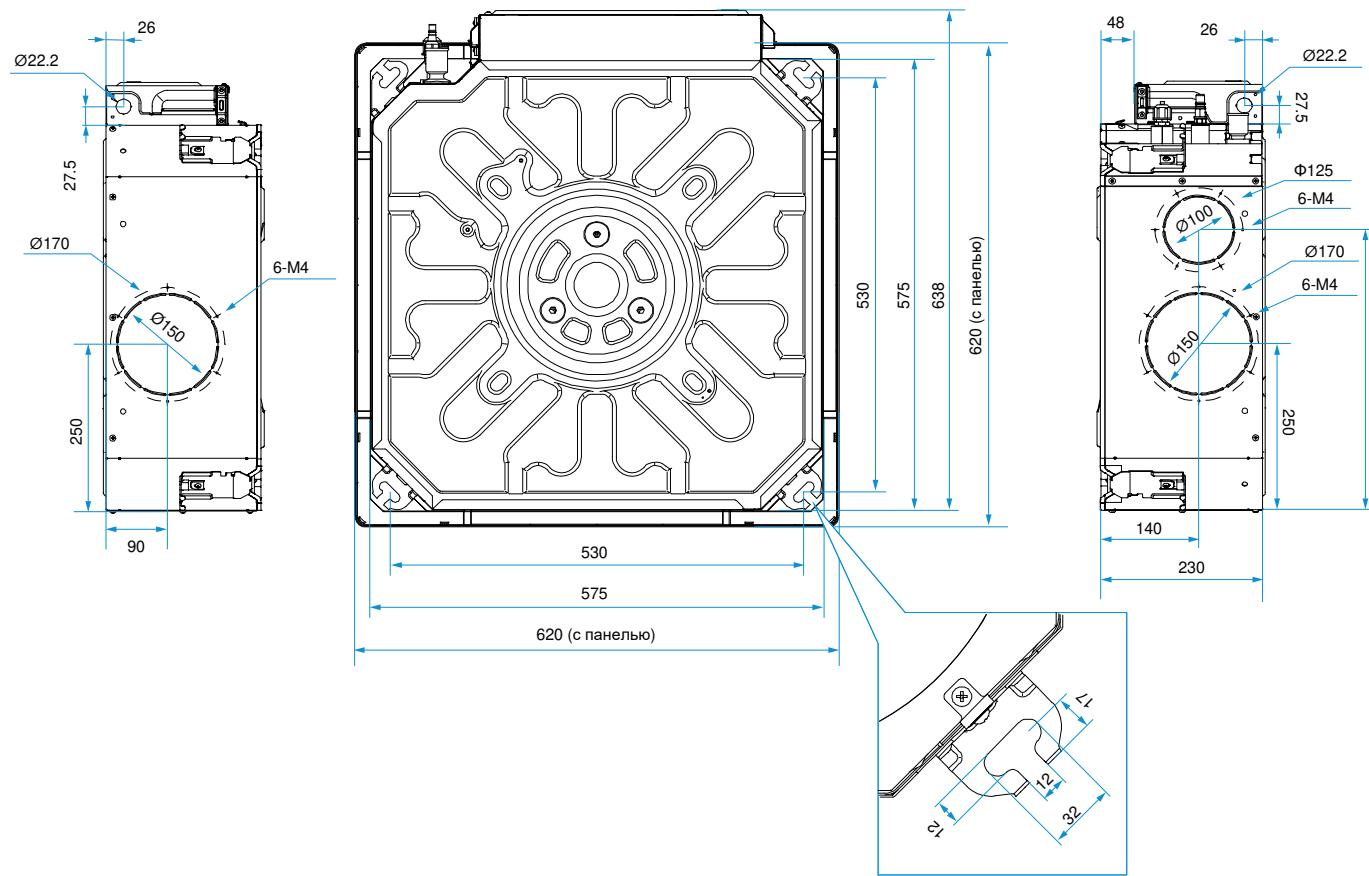
**Габаритные размеры внутренних четырехпоточных компактных кассетных блоков MI2\_Q4C**
