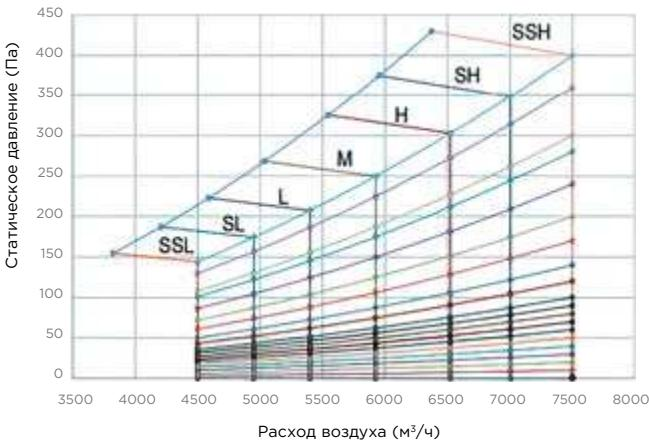
Как читать диаграмму (режим постоянного расхода воздуха). По вертикальной оси отложено внешнее статическое давление (Па), в то время как горизонтальная ось представляет расход воздуха ( $\text{м}^3/\text{ч}$ ). Указаны кривые для разных скоростей: SSH, SH, H, M, L, SL и SSL.
