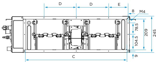
Размер воздухозаборного отверстия для обратного воздуха (режим нижнего возврата воздуха)
