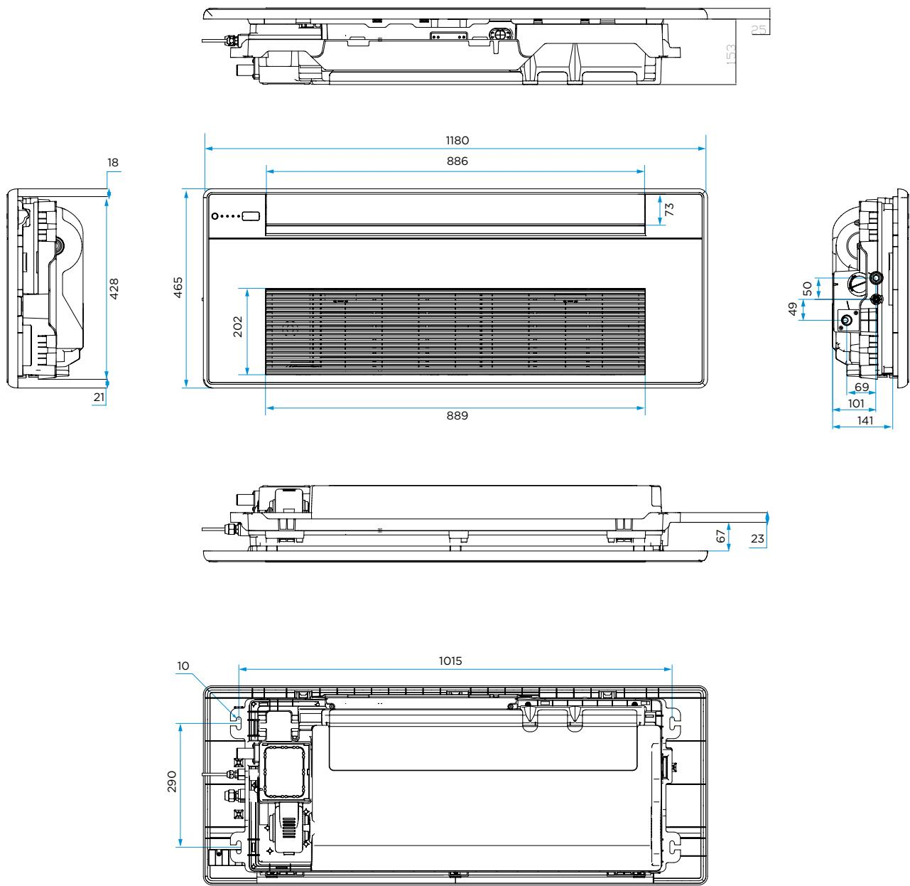
**Габаритные размеры внутренних однопоточных кассетных блоков MIH\_Q1HN18**
