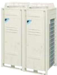
Представлена **новая система VRV IV**. Управление температурой кипения хладагента обеспечивает наилучший баланс между поддержанием комфортных условий в помещении и высокой энергоэффективностью. Технология непрерывного отопления основана на использовании уникальной теплоаккумулирующей секции. Благодаря ей во время оттаивания теплообменника наружного блока обогрев помещения не прерывается, сохраняются комфортные условия. Внедрена компьютеризированная методика (системный конфигура-
