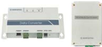
Шлюз Modbus предназначен для интеграции центральных многозональных систем кондиционирования DX PRO в систему управления зданием (BMS) по протоколу Modbus RTU или TCP. К одному шлюзу KCB-13 можно подключить одну систему кондиционирования DX PRO (в системе может быть объединено до 4 наружных модулей и до 64 внутренних блоков). В одну Modbus-сеть можно объединить до 16 устройств KCB-13 или KCB-33 с возможностью управления 1024 внутренними блоками и 64 наружными.
